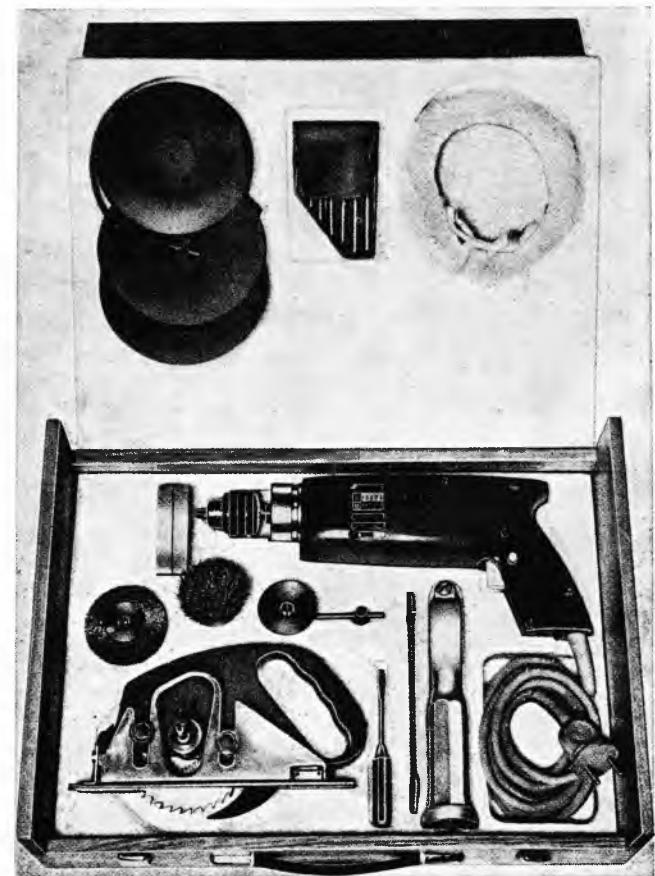
Sl. 51. Garnitura univerzalnog alata koji se može priključiti na električni stroj za bušenje
