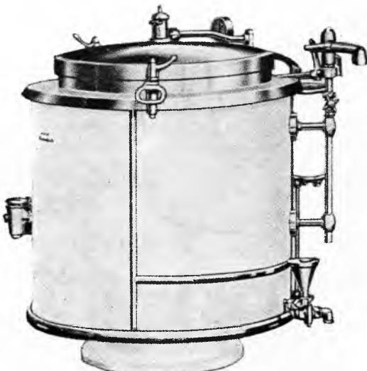
Sl. 21. Električni kotao za kuhanje s elektrodnim grijanjem. Kotao se sastoji od unutarnjeg i vanjskog kotla. Unutarnji kotao grijuje se parom od vode zagrijavane strujom koja prolazi kroz nju između više pari elektroda. Snaga se regulira ventilom kojim se mijenja količina povratne kondenzirane vode
