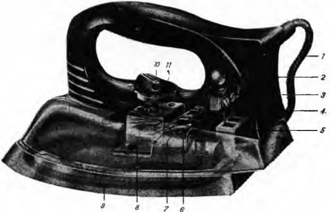
Sl. 38. Električno glačalo s bimetalnim termostatom. 1 Priključni gajtan, 2 signalna žaruljica, 3 priključne stezaljke, 4 priključci termostata, 5 keramički izolator, 6 pomični kontakt termostata koji se ručno postavlja a kojim upravlja bimetala traka, 7 fiksni kontakt termostata, 8 bimetala traka s kontaktnim krakom, 9 ploča za glačanje s grijajućom spiralom, 10 osovina regulatora, 11 dugme regulatora
