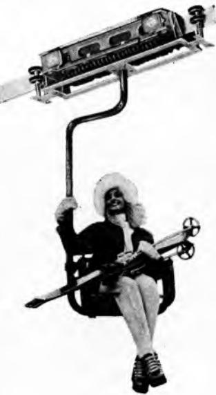
Sl. 298. Primjena linearnog motora s progresivnim gibanjem na skijaškoj uspinjači
