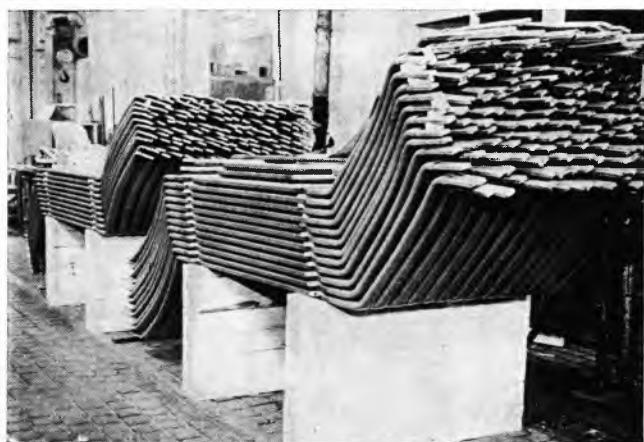
Sl. 56. Štapovi statorskog namota sinhronog generatora velike snage
