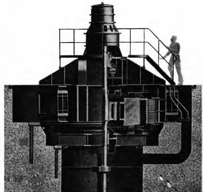
Sl. 235. Hidrogenerator s vertikalnom osovinom
