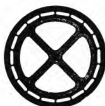
Sl. 21. Solidal kabel koji se izrađuje s punim žilama od aluminijuma
