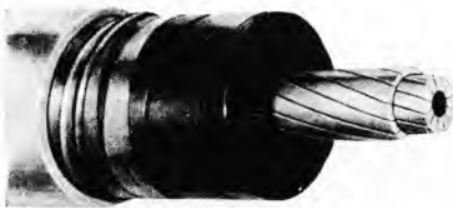
Sl. 65. 300 kV-ni kabel sa šupljim vodičem (za prolaz ulja) koji je sukan iz predprofiliranih žica
