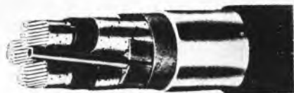
Sl. 86. 33 kV trožilni uljni kabel s ekraniziranim žilama. Prolaz za ulje nalazi se u ispuni a aluminijumski plašt ima antikoroziivnu zaštitu
