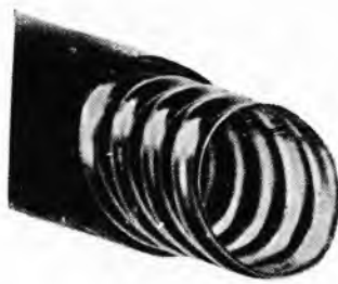
Sl. 94. Valovod izrađen od ovalne valovite bakrene cijevi
