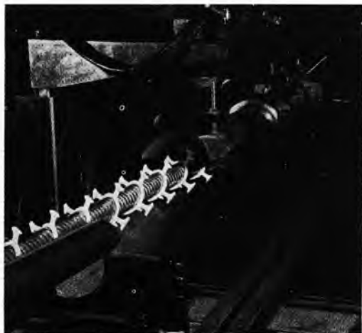
Sl. 93. Stroj za uzdužno zavarivanje uzdužnih bakrenih traka koje sačinjavaju vanjski vodič koaksijalnog kabela
