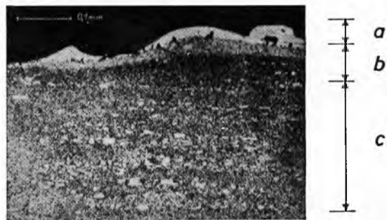
Sl. 22. Metalografski snimak dijela provrta. a Bijeli, tvrdi površinski sloj, b prelazni sloj, c osnovni nepromijenjeni sloj
