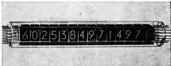
Sl. 52. Pokazivačka elektronka sa 14 odvojenih pokazivačkih sistema; upotrebljava se u instrumentima s digitalnim očitavanjem
