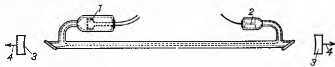
Sl. 54. Plinski laser. 1 Katoda, 2 anoda, 3 ogledalo, 4 izlazni snop svjetla
