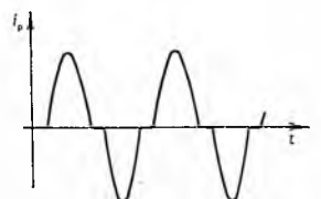
Sl. 68. Struja trošila u protutaktnom pojačalu klase B
