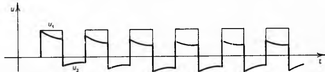
Sl. 254. Prijelazno stanje pri pobudi CR-mreže pravokutnim naponom; napon na izlaznom otporniku
