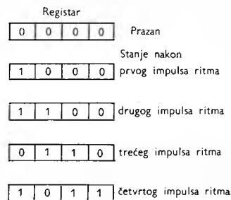
Sl. 337. Djelovanje posmačnog registra. Upis podatka 1011
