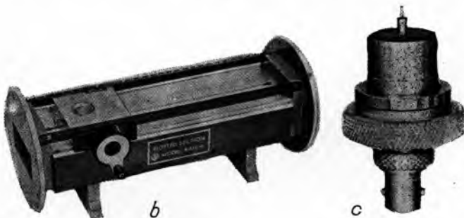
Sl. 29. Mjerna linija. a Presjek, b izgled, c izgled sonde s kristalom. 1 Antena za mjerenje stajnih valova, 2 valovod, 3 pomični suport
