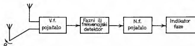
Sl. 20. Blok-shema goniometra s cikličkim mjerenjem faze
