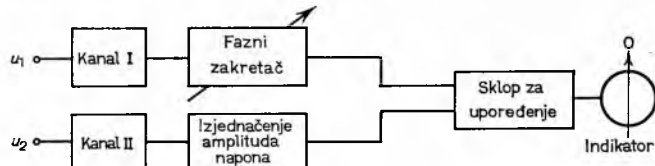
Sl. 21. Blok-shema za ručno mjerenje faze metodom kompenzacije
