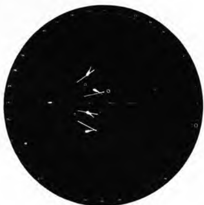
Sl. 53. Slika brodova (koji plove) na radarskom ekranu čiji svjetleći sloj ima veću persistenciju. Iza brodova vide se kratki tragovi iz kojih se može odrediti kurs tih objekata
