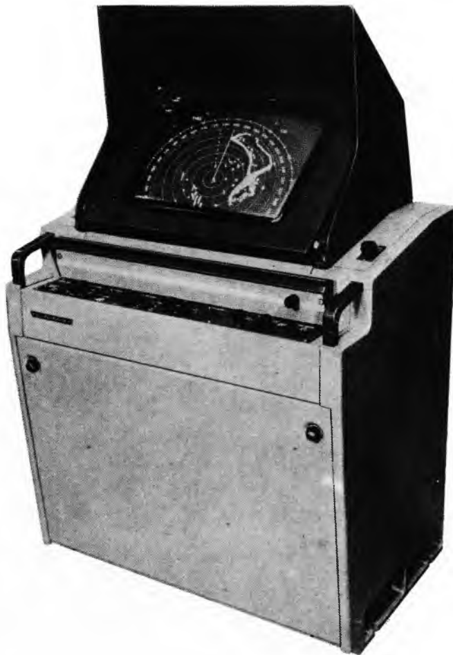
Sl. 54. Pokazivač situacije firme Kelvin i Hughes u kome se putem televizije prenosi s radarskog ekrana slika kojoj se dodaju i različite značke, skala itd.
