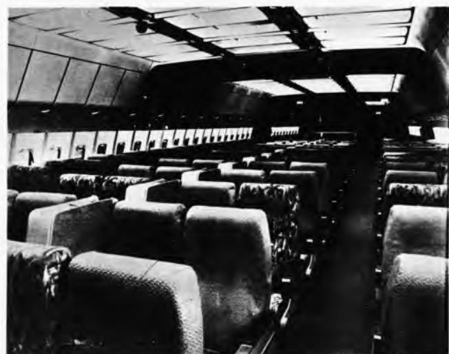
Sl. 29. Unutrašnje osvetljenje putničke kabine na savremenim avionima je fluorescentno i uniformno, i može se po želji smanjiti ili pojačati (Avion Lockheed Tri-star L-1011)
