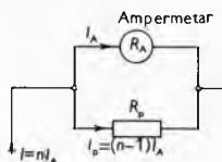
Sl. 20. Proširenje mjernog područja ampermetra paralelnim otpornikom otpora  $R_p$
