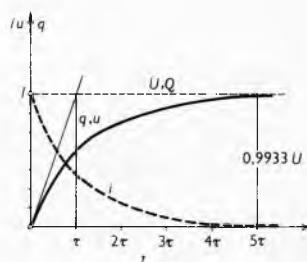
Sl. 47. Eksponencijalni porast naboja i napona uz eksponencijalno smanjenje jakosti struje prilikom priključka kondenzatora na izvor konstantnog istosmjernog napona
