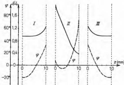
Sl. 125. Grafički prikaz amplitudne i fazne raspodjele struja po površini beskonačnih ploča kojima protjeće trosazni simetrični sustav struja
