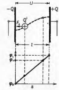
Sl. 34. Određivanje potencijala u homogenom električnom polju pločastog kondenzatora
