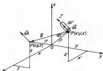
Sl. 111. Proračun vektorskog potencijala proizveden elementom strujnice
