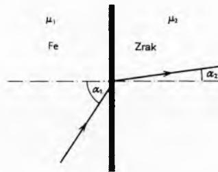
Sl. 56. Lom magnetskih silnica pri prijelazu iz feromagnetskog materijala u zrak
