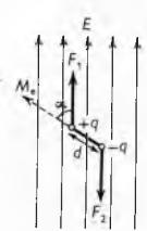
Sl. 36. Uz tumačenje električnog momenta elementarnih dipola
