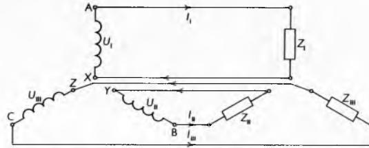
Sl. 83. Spojna shema opterećenog transformatora
