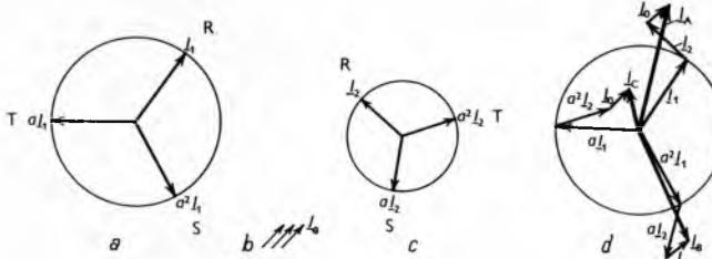
Sl. 94. Uz tumačenje simetričnih komponenata. a Direktna komponenta, b nulta komponenta, c inverzna komponenta, d zbrajanje simetričnih komponenata
