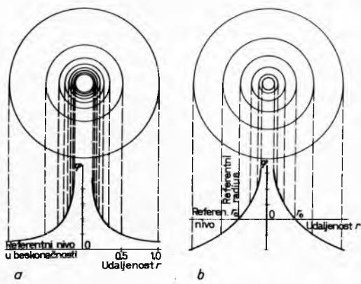
Sl. 106. Potencijalna polja: a) točkastog naboja, b) linijskog naboja
