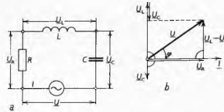
Sl. 76. Opterećenje izvora izmjenične struje otpornikom, induktivnim svitkom i kondenzatorom u serijskom spoju.
