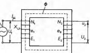
Sl. 82. Spojna shema neopterećenog transformatora
