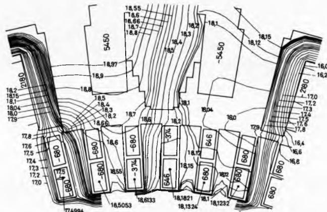
Sl. 136. Detalj raspodjele toka u komutacionoj zoni istosmjernog stroja pod punim teretom
