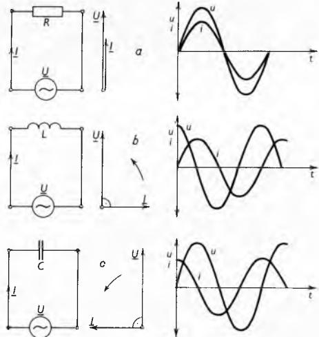
Sl. 75. Omsko (a), induktivno (b) i kapacitivno opterećenje (c) izvora izmjenične struje. Za sva tri slučaja prikazani su: spojna shema (lijevo) vektorski dijagram (u sredini) i vremenski dijagram (desno)
