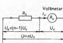
Sl. 21. Proširenje mjernog područja voltmetra serijskim otpornikom otpora  $R_s$
