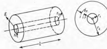
Sl. 43. Cilindrični kondenzator
