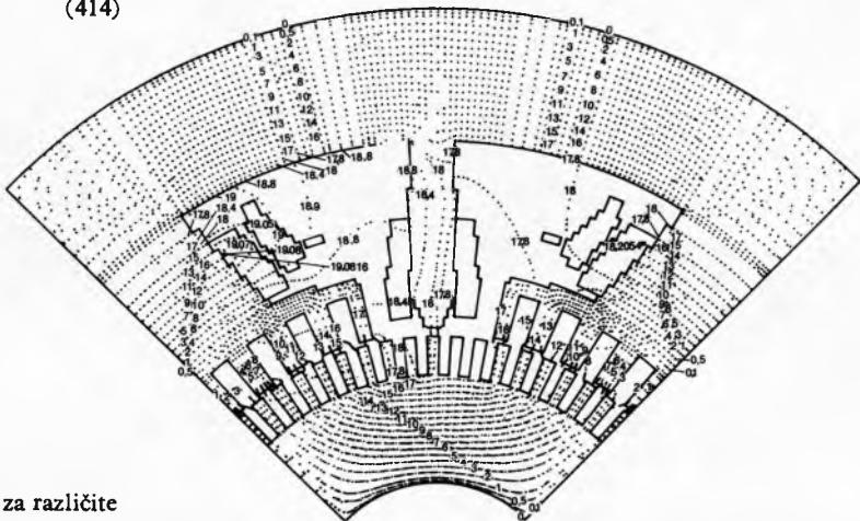
Sl. 135. Raspodjela nelinearnog magnetskog polja pod jednim polnim korakom u istosmjernom električnom stroju, prikazana linijama  $A = \text{konst}$
