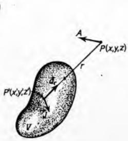
Sl. 98. Uz određivanje vektorskog potencijala u točki  $P$ , prema (163 b)
