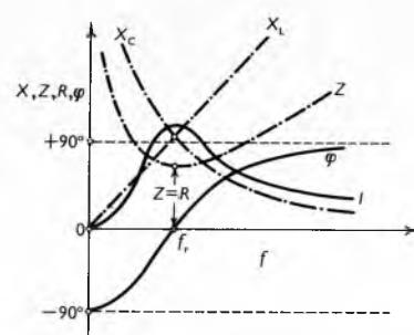
Sl. 80. Frekvencijska karakteristika: kapacitivni otpor  $X_C$ , induktivni otpor  $X_L$ , impedancija  $Z$ , fazni kut  $\varphi$  i struje  $I$  kad su otpornik, svitak i kondenzator priključeni u seriju na izvor izmjenične struje promjenjive frekvencije
