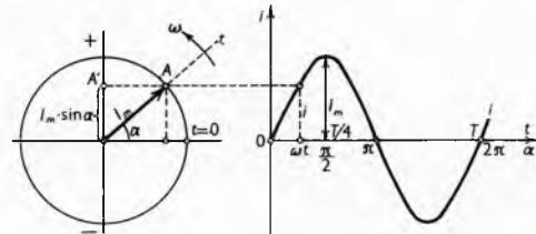
Sl. 73. Usporedni prikaz iste trenutne vrijednosti izmjenične struje vremenskim dijagramom (desno) i položajem radijvektora (lijevo)
