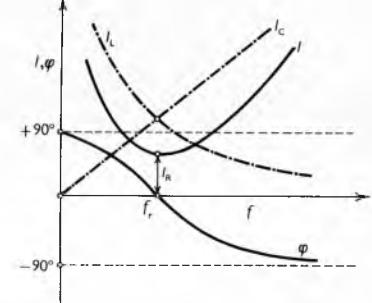
Sl. 81. Frekvencijska karakteristika: ukupne struje  $I$ , struje kroz kondenzator  $I_C$ , struje kroz svitak  $I_L$  i fazni kut  $\varphi$  pri paralelnom spoju otpora, svitka i kondenzatora na izvor izmjenične struje promjenjive frekvencije
