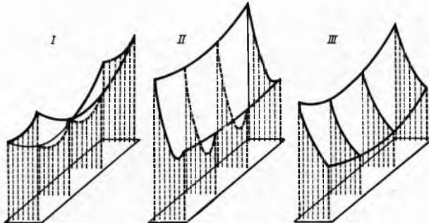
Sl. 127. Grafički prikaz raspodjele vršnih vrijednosti struja po površinama presjeka ravnih vodiča trofaznog sustava
