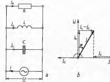
Sl. 77. Opterećenje izvora izmjenične struje otpornikom, induktivnim svitkom i kondenzatorom u paralelnom spoju.
