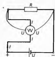
Sl. 18. Način priključka vatmetra, tj. instrumenta za mjeđenje snage, u strujni krug
