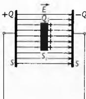
Sl. 31. Odvajanje naboja na metalnoj ploči influencijom djelovanjem električnog polja
