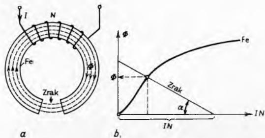
Sl. 55. Određivanje magnetskog toka u prstenu sa zračnim rasporom (a) uz zadatu uzbudu  $IN$  grafičkim putem (b). Iz točke zadane uzbude na apscisi povuče se u obratnom smislu pod poznatim kutem  $\alpha$  linija magnetiziranja zraka. Sjedište je vrijednost dobivenog toka  $\Phi$
