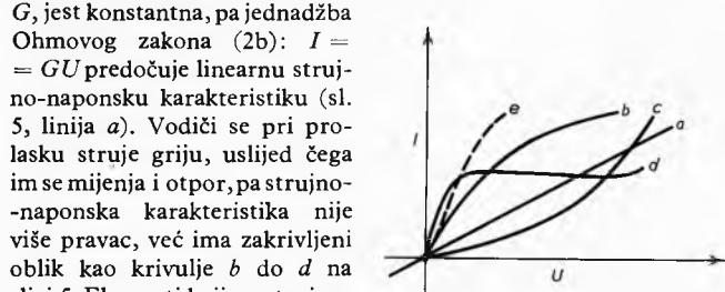
Sl. 5. Strujno-naponske karakteristike: a) linearna, b) žarulje s metalnom niti, c) žarulje s ugljenom niti, d) željezne žice u atmosferi vodika, e) vakuumske diode
