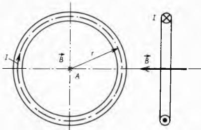
Sl. 58. Gestoča magnetskog toka  $B$  u središtu kružnog zavoja
