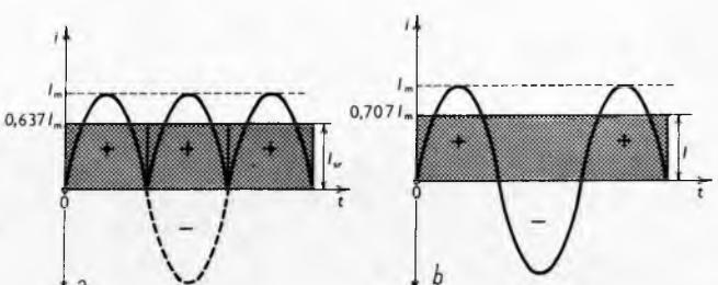
Sl. 70. Prosječne vrijednosti izmjenične struje. a Srednja vrijednost ispravljene izmjenične struje, b efektivna vrijednost
