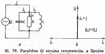
Sl. 79. Paralelna ili strujska rezonancija. a) Spojna shema, b) vektorski dijagram
