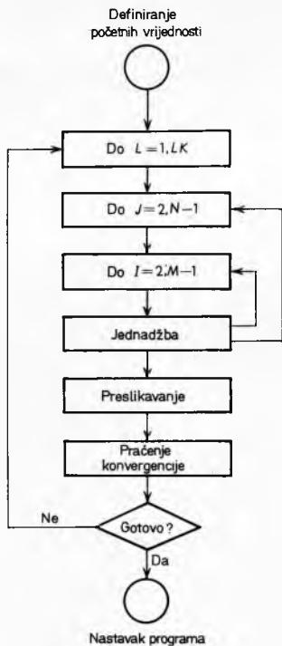
Sl. 134. Blok-dijagram iterativnog dijela programa za proračun vektorskog potencijala  $A$
