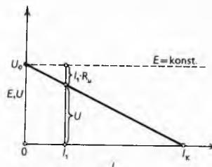
Sl. 8. Vanjska karakteristika izvora napajanja.  $U_0$  Napon stezaljki pri praznom hodu,  $I_k$  struja pri kratkom spoju
