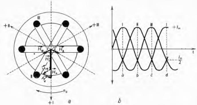
Sl. 93. Shematski prikaz trofaznog stroja (a) s ucrtanim vektorima uzbude i vremenski dijagram uzbudnih struja u pojedinim svicima stroja (b)
