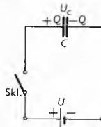
Sl. 25. Priključak kondenzatora na izvor konstantnog napona
