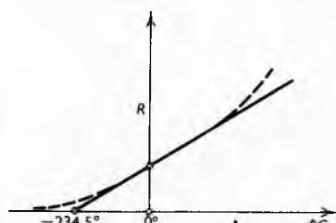
Sl. 3. Ovisnost otpora bakra o temperaturi. Crtkana linija prikazuje stvarni otpor
