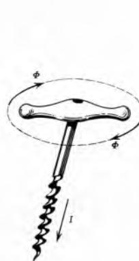
Sl. 52. Uz pravilo vadičepa ili desnog vijka za određivanje smjera magnetskog polja vodiča kroz koji protjeće struja
