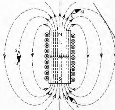
Sl. 48. Magnetske silnice elektromagneta
