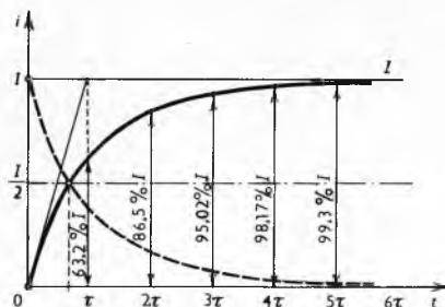
Sl. 64. Eksponencijalni porast struje pri priključku svitka na izvor konstantnog napona (puna krivulja) i eksponencijalno opadanje struje (crtkana linija) pri isključenju
