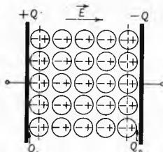
Sl. 37. Polarizacija materije izolatora u homogenom električnom polju kondenzatora
