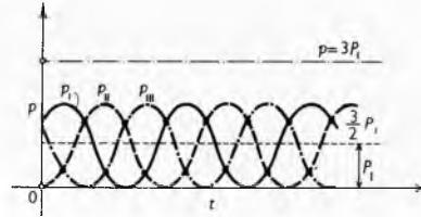
Sl. 92. Snaga trofazne struje.  $p_1$ ,  $p_{II}$  i  $p_{III}$  Trenutne snage pojedinih faza pri čisto omskom simetričkom opterećenju
