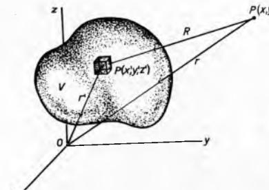
Sl. 97. Uz određivanje skalarnog potencijala u točki  $P$ , prema (162 b,c)
