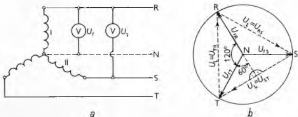
Sl. 89. Fazne i linijske vrijednosti četverožičnog trofaznog sustava u zvijezdi.
