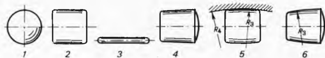
Sl. 212. Valjni elementi valjnih ležaja. 1 Kuglica, 2 valjak, 3 iglica, 4 krnji stožac, 5 simetrična bačvica, 6 asimetrična bačvica
