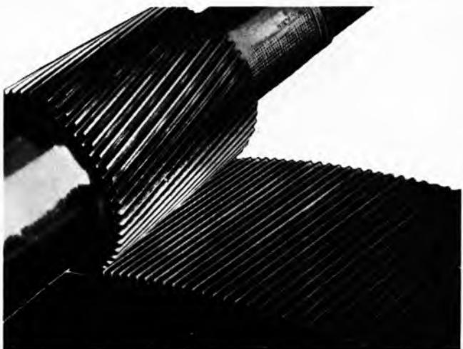
Sl. 312. Čelnik s kosim zubima izrađen zajedno s vratilom u jednom komadu
