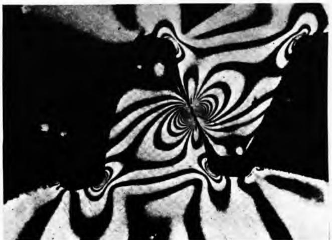
Sl. 284. Snimak zubā zupčanika u zahvatu u polariziranom svjetlu
