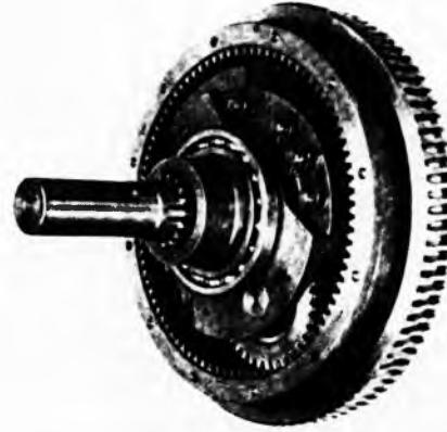
Sl. 369. Izgled dijelova jednog planetnog reduktora
