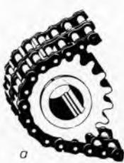
Sl. 378. Temeljni oblici pogonskih lanaca: a - valjkasti, b - zupčani
