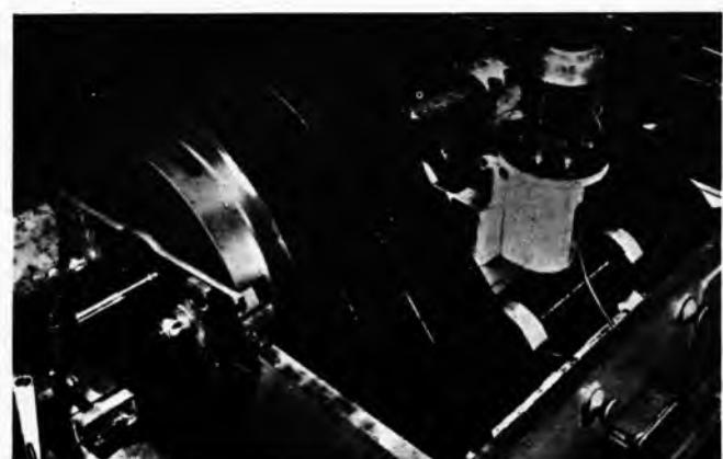
Sl. 248. Pogon specijalne brusilice prijenosom s uskim klinastim remenjem
