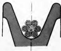
Sl. 256. Presjek žljebova vijenca užnice s pletenim čeličnim užetom
