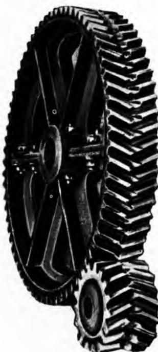
Sl. 307. Izgled dvodijeljnog lijevanog zupčanika sa strelastim zubima
