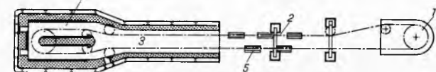
Sl. 5. Kontinuirana tunelna peć u obliku slova U. 1 Upravljanje transporterom, 2 vješanje robe s nanesenom emajlnom masom na transporter, 3 zona izmjene topline (sušenje emajlne mase toplinom ispečene robe), 4 zona pečenja, 5 skidanje ispečene robe s transportera
