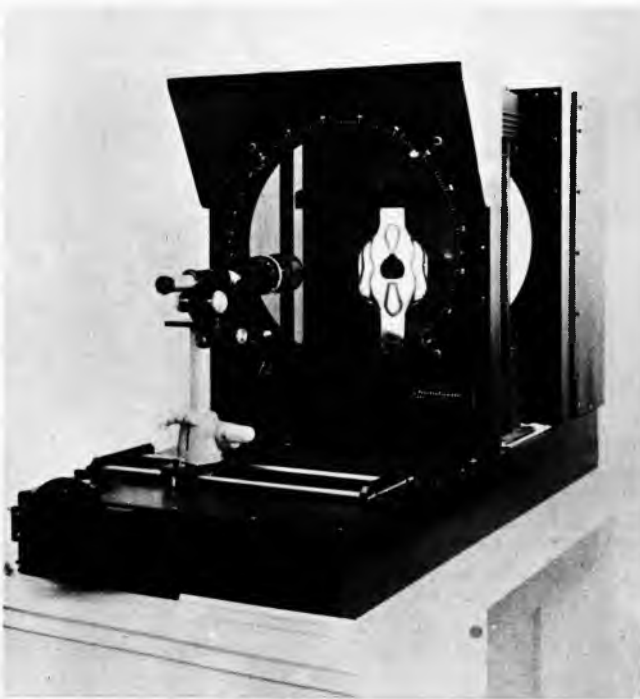
Sl. 5. Polariskop s mutnim staklom i polaroidnim filtrima
