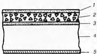
Sl. 45. Presjek fotografskog materijala, shematski prikazan. 1 Zaštitni sloj, 2 emulzijski sloj, 3 vezivni sloj, 4 podloga, 5 antihalo-sloj, odnosno NC-sloj protiv uvijanja filma
