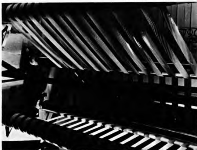
Sl. 84. Stroj za rezanje filma u trake. Trake se naizmjenice vode preko gornjeg, odnosno donjeg valjka i namataju na odvojene jezgre (kalemove)
