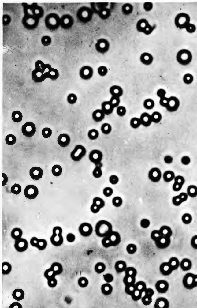
Sl. 46. Kristalići srebro-halogenida, mikroskopska snimka uz povećanje ~1500 puta. a Krupnozrna, b sitnozrna emulzija
