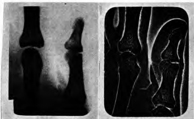
Sl. 101. Usporedbene snimke dobivene a na rendgen-filmu, b kserografskim postupkom
