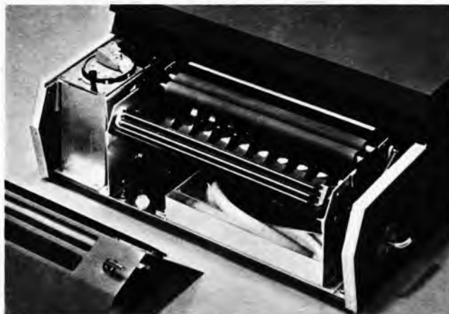
Sl. 95. Aparat za difuzijsko kopiranje Luxacopy
