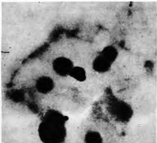
Sl. 85. Centri razvijanja: (snimka elektronskim mikroskopom) konture zrna se razabiru po repliki ugljikom, dok je srebro-bromid fiksiranom otopinom uklonjen
