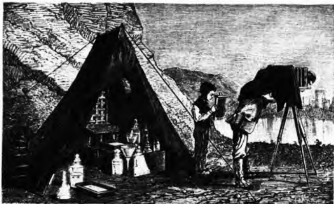
Sl. 6. Prijenosna šatorska tamna komora za fotografsku obradu po mokrom postupku (oko 1865)
