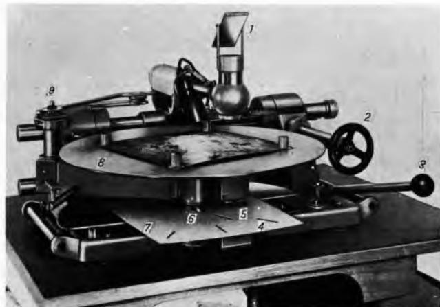
Sl. 35. Radialssecator RS I (OFO). 1 Uvid u vidno polje, 2 komanda za radijalni postav, 3 komanda za izrezivanje razreza, 4 perforirani fragment zrake kroz odabranu mjerenu točku, 5 radijani perforator, 6 centralni perforator, 7 šablon, 8 nosač snimka, 9 ekscentar za kompenzaciju utjecaja nadirnog otklona
