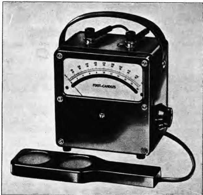
Sl. 41. Fotoelektrički luksmetar za mjerjenje slabih osvjetljenja
