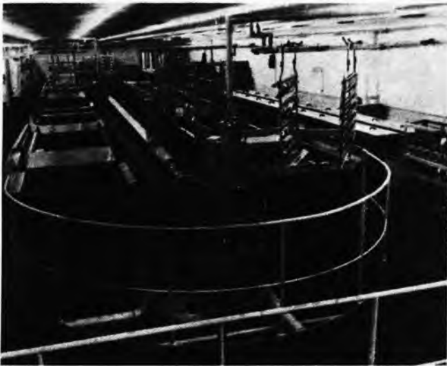
Sl. 18. Kružno postrojenje za galvanotehničko pocinčavanje ili kadmiziranje komadne robe
