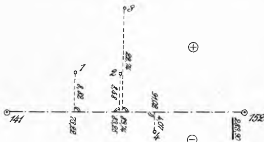
Primjer 7. Skica za računanje koordinata detaljnih točaka
