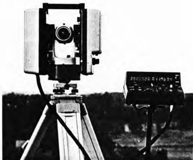
Sl. 72. Elektronički tahimetar s registracijom podataka Geodimetar 710
