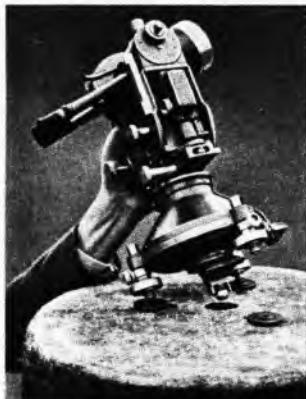
Sl. 11. Precizno centriranje teodolita na betonskom stupu (točnost nekoliko stotinki milimetra)
