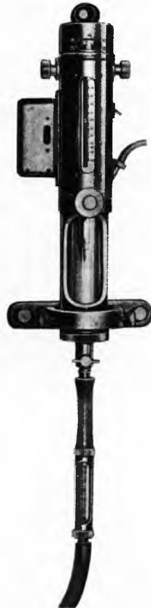
Sl. 61. Mjerni sustav prečizne hidrostatske vage s indikatorom
