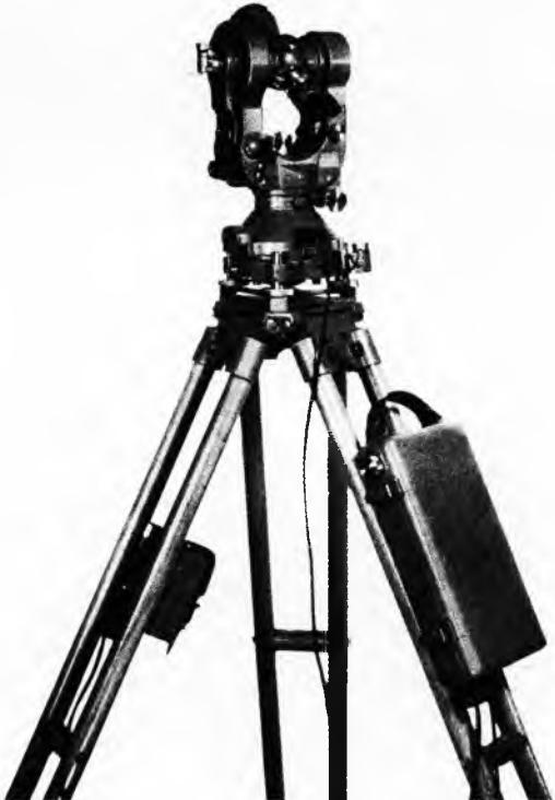
Sl. 24. Teodolit s priključenom električnom rasvjetom
