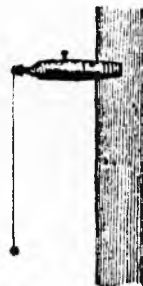
Sl. 25. Signal za viseći teodolit
