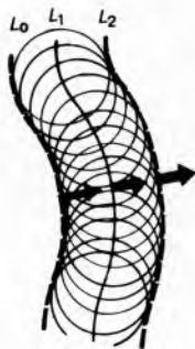
Sl. 15. Formiranje fronte seizmičkog vala na principu Huygensova zakona
