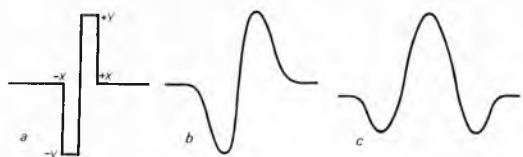
Sl. 21. Nastanak elementarnog seizmičkog valića. a) impulsni signal eksplozije, b) filtrirani oblik uzdužne deformacije, c) signal registriran na elektrodinamičkom geofonu
