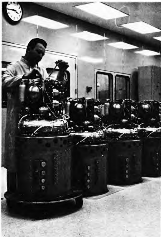
Sl. 7. Gorivni elementi s vodikom i kisikom upotrijebljeni u američkim svemirskim letjelicama (Apollo, Skylab)
