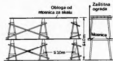
Sl. 10. Izvedba skele od nogara
