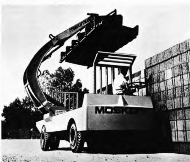
Sl. 13. Vozilo s uređajem za utovar elemenata za zidanje
