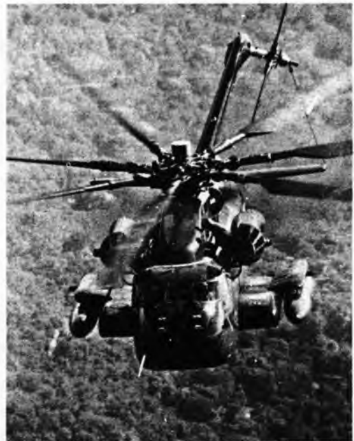
Sl. 5. Helikopter Sikorsky YCH-53E. Na slici je vidljiva promjena cikličnog koraka pojedinih lopatica rotora
