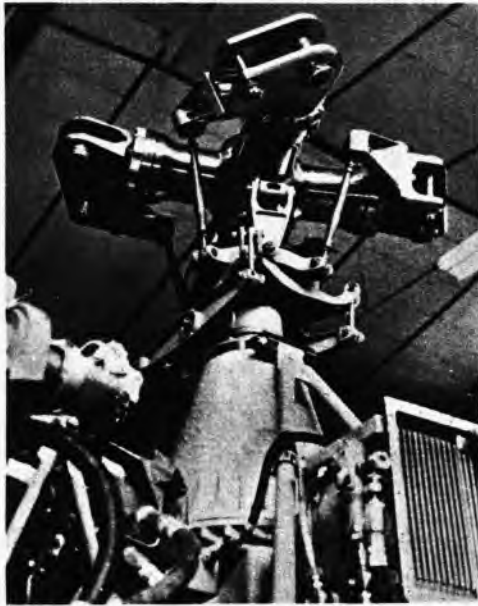
Sl. 11. Glava semirigidnog rotora koja omogućuje samo promjene koraka
