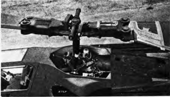
Sl. 10. Glava rotora s titanskom pločom za elastično mahanje
