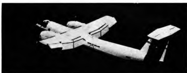
Sl. 19. Transportni avion NASA/DHC-8 Buffalo s uređajem za uvođenje energije ispušnih plinova na donjaku krila
