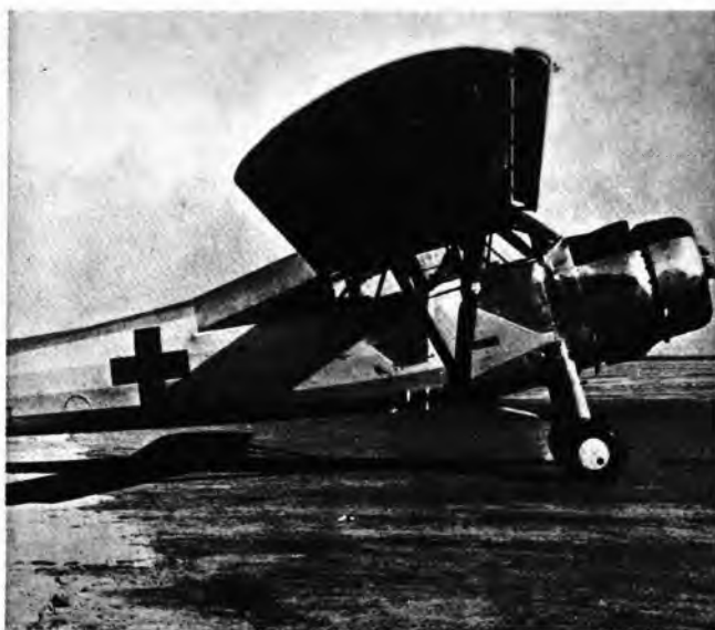
Sl. 6. Pomično pretkrilce na cijeloj dužini napadne ivice krila
