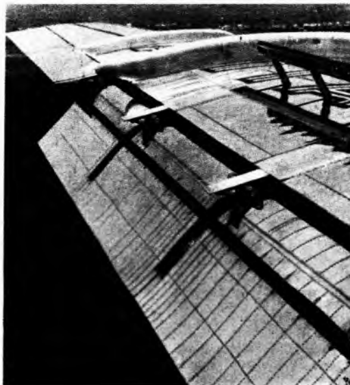
Sl. 13. Krilo mlaznog aviona s oborenim Fowler-zakrilcima; na gornjaci vidi se izvučena aerodinamička kočnica, tzv. spoiler
