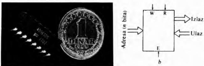
Sl. 91. Memorijska jedinica (chip). a vanjski izgled kućišta, b blok-sHEMA
