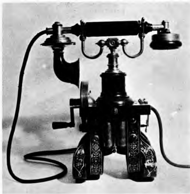
Sl. 2. Telefonski aparat: gore Eriksonov telefon iz 1894. (PTT muzej, Zagreb), dolje suvremena izvedba
