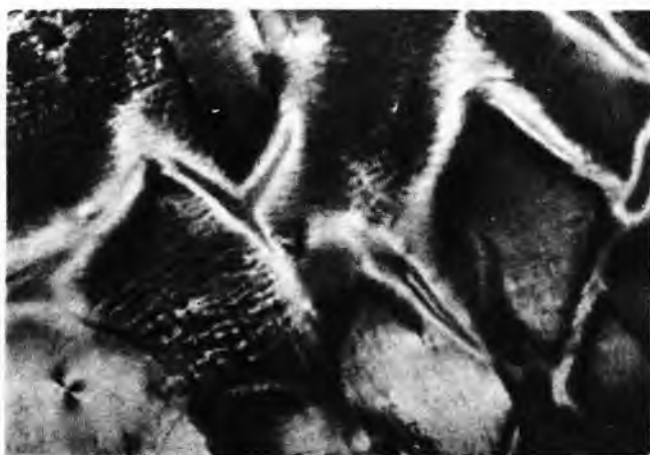
Sl. 2. Snimka presjeka betonske kocke pod tlakom. Presjek je kocke prevučen fotoelastičnim lakom i snimka je načinjena pomoću polariziranog svjetla
