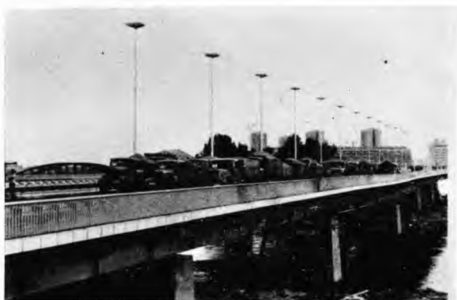
Sl. 46. Pokusno opterećenje mosta vozilima
