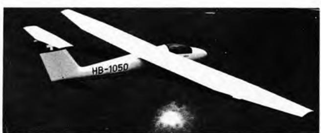
Sl. 18. Visokosposobna standardna jedrilica metalne konstrukcije Pilatus B4
