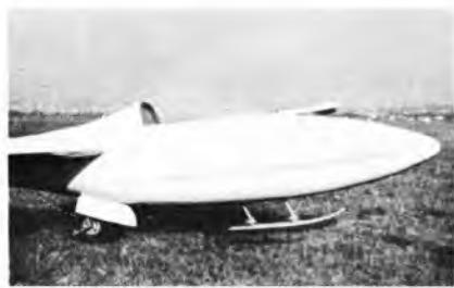
Sl. 89. Stajni trap izveden kao kotač sa skijom (na uvlačenje)
