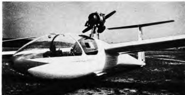
Sl. 38. Motorna jedrilica D-37 s motorom koji se, kad je izvan upotrebe, uvlači u trup
