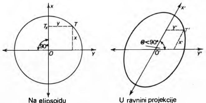
Sl. 3. Preslikavanje kružnice na elipsoidu u ravninu
