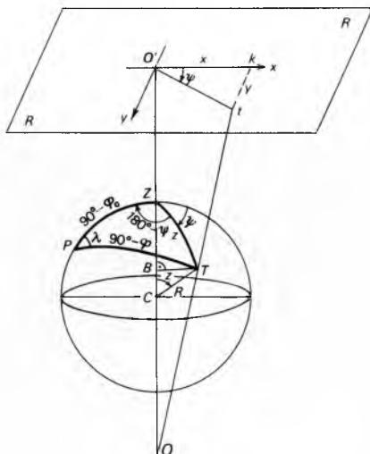
Sl. 31. Projekcija točke  $T$  elipsoida ili kugle bit će točka  $t$ , u kojoj zraku  $OT$  probada ravninu  $RR$
