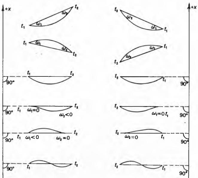
Sl. 22. Izgled geodetske linije u ravnini Gauss-Krügerove projekcije kad se obje točke nalaze na istoj strani osi  $x$
