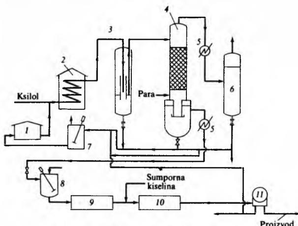
Sl. 9. Shema procesa proizvodnje tereftalne kiseline oksidacijom *p*-ksilola amonij-sulfatom. 1 rezervoar za otopinu amonij-sulfata, 2 predgrijać, 3 reaktor, 4 stripper, 5 hladnjaci, 6 oksidator, 7 mijesalica za otapanje, 8 adsorber, 9 filter, 10 hidrolizator, 11 centrifuga
