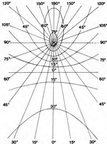
Sl. 41. Izgled meridijana i paralela u središnjoj horizontalnoj projekciji (za  $\varphi_0 = 44^\circ$ )
