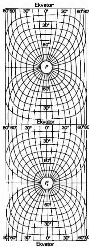
Sl. 26. Mreža meridijana i paralela u poprečnoj ekvivalentnoj cilindričnoj projekciji
