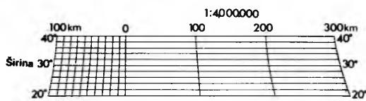
Sl. 2. Razmjernik mjesnih mjerila u cilindričnim projekcijama
