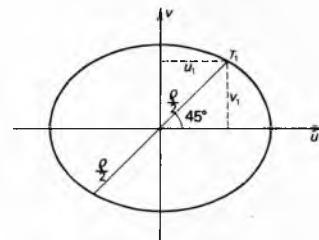
Sl. 53. Odnos promjera elipse deformacija koji s njezinim osima zatvara kut od  $45^\circ$
