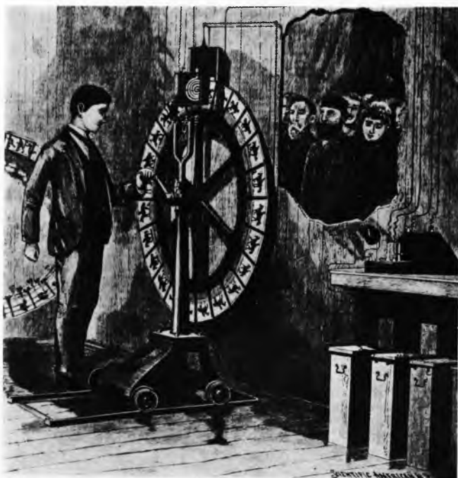
Sl. 6. Anschützov elektrotahiskop prikazan na Izložbi u Chicagu 1893, kojim se sjedinjuju pokreti snimljeni na slijedu posebnih slika
