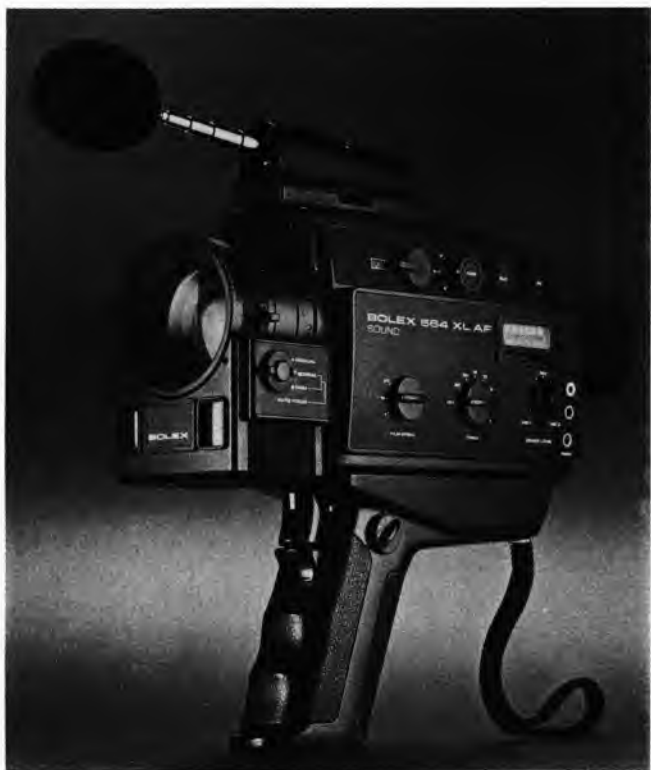
Sl. 22. Amaterska tonska supstandardna kamera formata super 8 sa zoom-objektivom 1:1,2/f = 8 \text{ } 48 \text{ mm} ( 6\times ), s automatskim osvjetljavanjem i automatskim izoštravanjem slike (integrirani krug uspoređuje slike s dvaju ogledala te servomotorom pomiče objektiv i tako izoštrava sliku)
