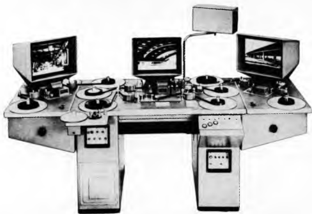
Sl. 49. Montažni stol sa tri ekrana na kojem se istodobno mogu kontrolirati tri vrpce slike i dvije zvuka (KEM)
