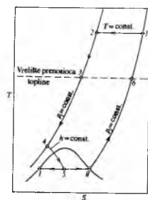
Sl. 9. TS-dijagram idealiziranog jednostavnog Lindeovog postupka ukapljivanja zraka s prethlađenjem
