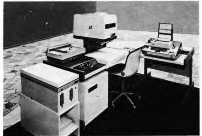
Sl. 7. Sustav za kolorimetrijska mjerenja Pretema 4000. a Pretema Spectromat FS-4, spektrofotometar sa 35 interferencijskih filtera (380-720 nm) i geometrijskim rasporedom mjerenja d/0^\circ , b ulaz i izlaz podataka za Pretema Color Computer PCC-200 X, c pisalo x, y
