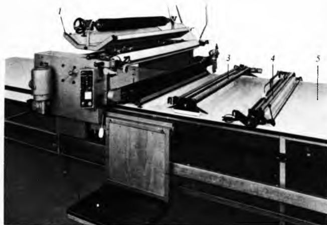
Sl. 4. Stroj za polaganje krojnih slojeva. 1 nosilo tekstilnog smotka, 2 držalo krojnih slojeva, 3 uređaj za dvosmjerno polaganje, 4 uređaj za polaganje i odrezivanje krojnih slojeva, 5 stolna ploča, 6 suvozna platforma za poslužitelja
