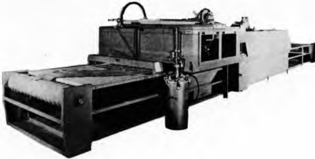
Sl. 21. Automat za apretiranje kože prskanjem
