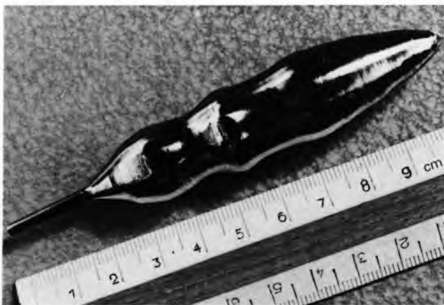
Sl. 21. Jedinični kristal germanija pripremljen metodom Czochralskoga (pripravio Z. Despotović, Institut Ruđer Bošković, Zagreb)
