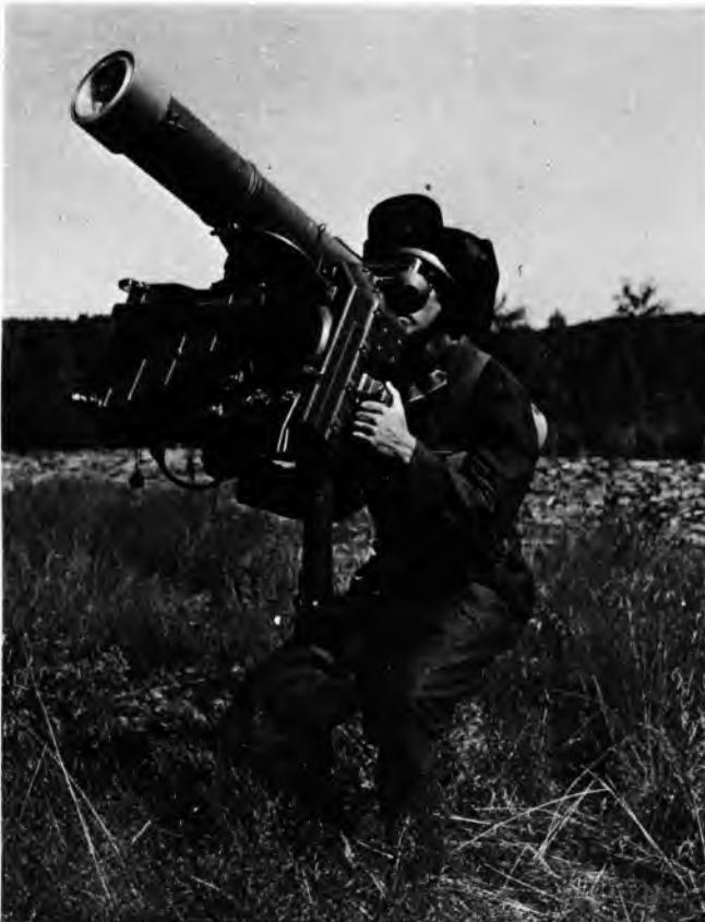
Sl. 66. Uredaj za lasersko navođenje protuavionskog oružja
