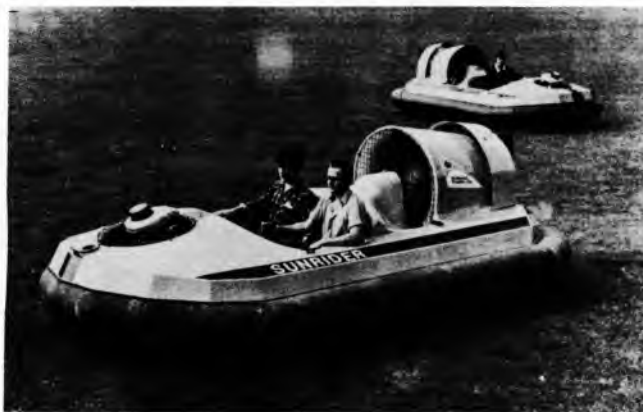
Sl. 19. Sportska lebdjelica Sunrider za dvije osobe; proizvođač Surface Flight Ltd., Velika Britanija. Dimenzije: duljina 4,06 m, širina 1,98 m, visina 1,12 m. Masa 480 kg. Za zagon i lebđenje služe dva 2-taktna benzinska motora. Brzina 56 km/h
