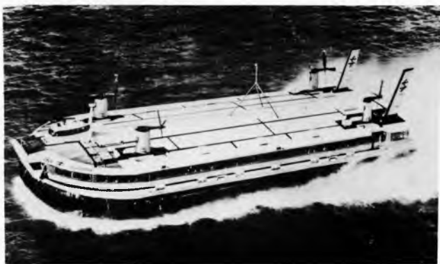
Sl. 16. Lebdjelica tipa Mountbatten SR.N4 Mk2 (British Hovercraft Corporation). Dimenzije: duljina 39,68 m, širina 23,77 m, visina u stanju lebđenja 11,48 m. Masa 200 t. Pogonski uređaj: četiri plinske turbine Rolls-Royce Marine Proteus, svaka snage 2535 kW (maksimalno 3170 kW). Uređaj za lebđenje: četiri radialna turbokompresora promjera 3,5 m. Zagon: četiri zračna vijka promjera 5,79 m. Brzina 130 km/h
