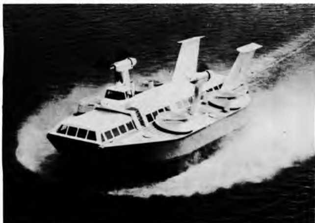
Sl. 17. Lebdjelica Naviplane N 300 tvrtke SEDAM, Francuska. Dimenzije: duljina 24 m, širina 10,5 m, visina u stanju lebđenja 7,5 m, visina elastičnih bočnih stijenki 2 m. Masa 27 t. Pogonski uređaj: dvije plinske turbine Turbomeca Turmo III N3 svaka snage 2237 kW. Uređaj za lebđenje: dva aksijalna turbokompresora promjera 1,9 m. Zagon: dva zračna vijka promjera 3,6 m. Brzina 115 km/h
