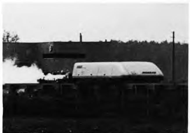
Sl. 34. Lebdeće pružno vozilo bez posade Komet. Dimenzije: duljina 8,5 m, širina 2,5 m, visina 1,5 m. Masa 8,8 t. Maksimalni potisak raketnog zagona 500 kN. Brzina 401,3 km/h
