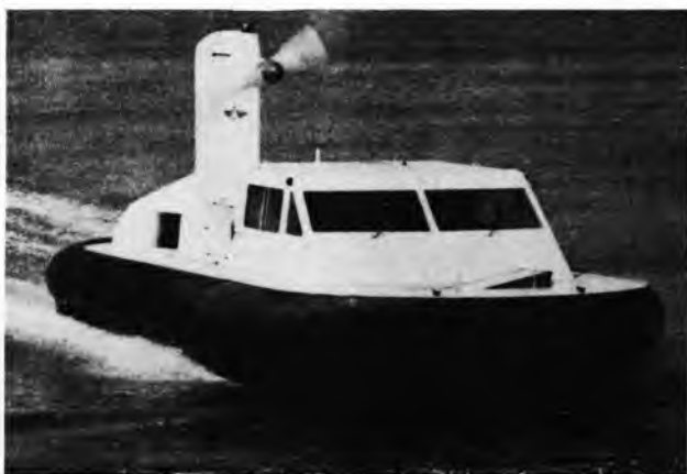
Sl. 20. Lebdjelica Missionaire Mk 1 za pet osoba. Proizvođač Missionary Aviation Fellowship, Velika Britanija. Dimenzije: duljina 6,70 m, širina 3,81 m, visina 2,84 m. Masa 1630 kg. Za lebđenje i zagon služe dva VW 4-taktna benzinska motora. Brzina 70 km/h
