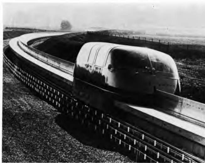
Sl. 33. Lebdeće pružno vozilo Transrapid 02 tvrtke Krauss-Maffei, SR Njemačka. Dimenzije: duljina 11,7 m, širina 2,9 m, visina 2,9 m. Masa 11,3 t. Za lebđenje služi elektromagnetski statički uređaj. Zagon asinhronim linearnim elektromotorom maksimalne vučne sile 31 kN
