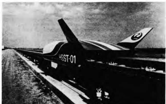
Sl. 32. Lebdeće pružno vozilo bez posade HSST-01, Japan Airlines. Dimenzije: duljina 4,2 m, širina 2,9 m, visina 1,1 m. Brzina 300 km/h
