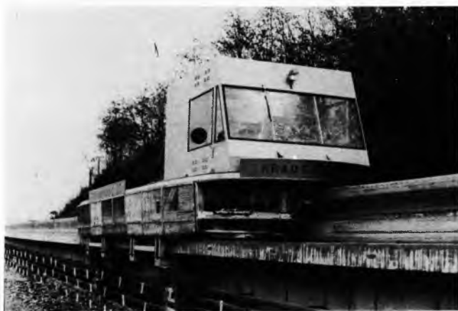
Sl. 26. Lebdeće pružno vozilo Transrapid 03 tvrtke Krauss-Maffei, SR Njemačka. Dimenzije: duljina 11,7 m, širina 2,9 m, visina 2,5 m. Masa 9,6 t. Lebđenje: šest zračnih jastuka za nošenje i osam zračnih jastuka za vođenje tipa površinski mlaznik. Svaki zračni jastuk ima vlastiti aksijalni turbokompresor tjeran elektromotorom; ukupna snaga svih 14 turbokompresora iznosi 178 kW. Zagon: asinhroni linearni elektromotor maksimalne vučne sile 29 kN. Brzina 140 km/h
