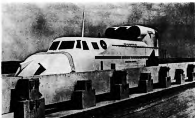
Sl. 28. Lebdeće pružno vozilo Grumman TLRV. Dimenzije: duljina 15,54 m, širina 3,65 m, visina 4,01 m. Masa 28,1 t. Uređaj za lebđenje i zagon u prvoj fazi ispitivanja: plinske turbine Canadian Pratt & Whitney JT 15D-I snage 1075 kW; četiri zračna jastuka za nošenje i četiri zračna jastuka za vođenje tipa rubni mlaznik. Zagon u drugoj fazi: linearni elektromotor Garrett maksimalne vučne sile 33,36 kN. Brzina 480 km/h
