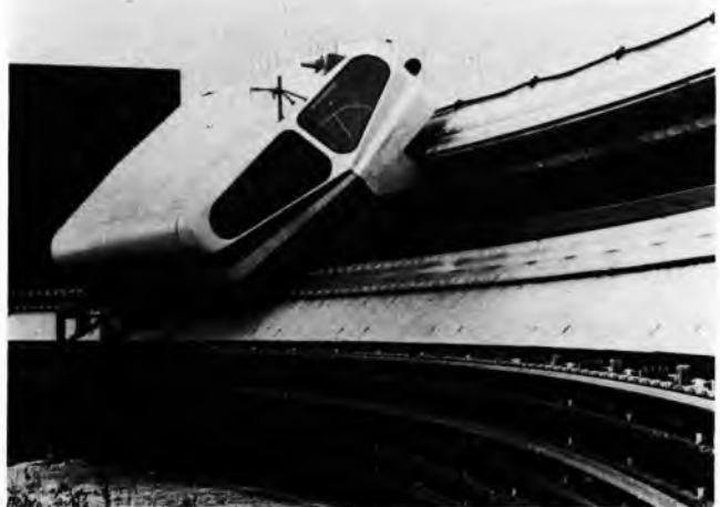
Sl. 29. Lebdeće pružno vozilo Erlanger Erprobungsträger EET. Dimenzije: duljina 12,3 m, širina 3,8 m, visina iznad ruba pruge 1,75 m. Masa 16 t. Lebđenje pomoću elektromagnetskog dinamičkog uređaja, a zagon pomoću asinhronog linearnog elektromotora AEG maksimalne vučne sile 35 kN
