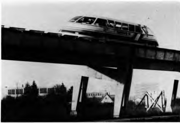
Sl. 35. Lebdeće pružno vozilo Transrapid 04 tvrtke Krauss-Maffei. Dimenzije: duljina 15,0 m, širina 3,4 m, visina 2,8 m. Masa 18,5 t. Lebdenje pomoću elektromagnetskog statičkog uređaja. Zagon asinhronim linearnim elektromotorom maksimalne vučne sile 35 kN. Brzina 253 km/h
