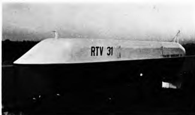
Sl. 27. Lebdeće pružno vozilo RTV 31, tvrtke Tracked Hovercraft Ltd., Velika Britanija. Dimenzije: duljina 22,15 m, širina 3,73 m, visina 3,76 m. Masa 23 t. Lebđenje: dva zračna jastuka za nošenje i šest zračnih jastuka za vođenje tipa rubni mlaznik s radijalnim turbokompresorima tjeranim elektromotorima ukupne snage 740 kW. Zagon: asinhroni linearni elektromotor maksimalne vučne sile 31 kN. Brzina ~400 km/h
