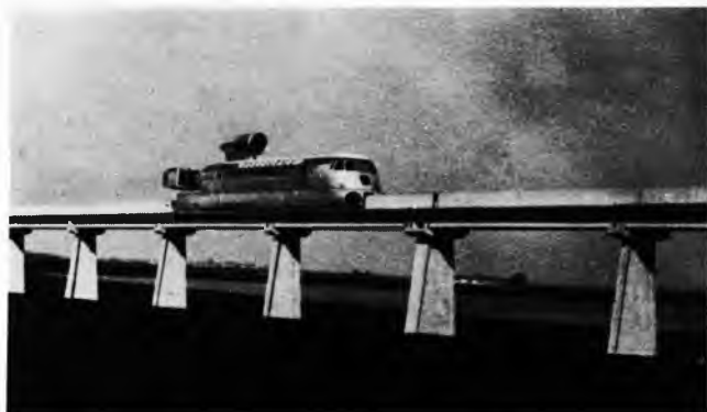
Sl. 25. Lebdeće pružno vozilo Aérotrain Interurbain I-80 HV Orléans. Duljina 30,5 m, širina 3,2 m, visina 5,1 m. Masa 28 t. Za zagon služi mlazni motor Pratt & Whitney JT 8D-II, s potiskom 66 kN i s posebnim prigušivačem buke. Uređaj za lebđenje jednak kao u vozila na sl. 24. Brzina 430 km/h
