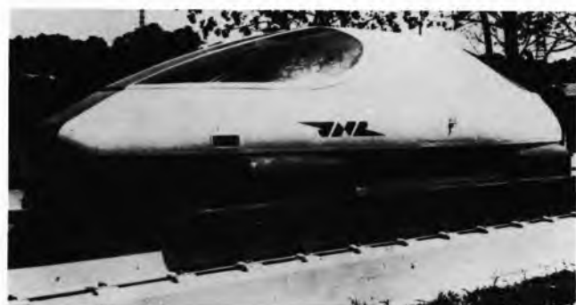
Sl. 31. Lebdeće pružno vozilo JNR Japanskih nacionalnih željeznica. Dimenzije: duljina 7,2 m, širina 5,2 m, visina 2,0 m. Masa 3,4 t. Brzina do 500 km/h
