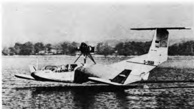
Sl. 21. Lebdjelica RFB X-113 AM; graditelj Lippisch Research Corporation, SAD, i Rhein Flugzeugbau, SR Njemačka. Dimenzije: raspon krila 5,89 m, duljina 8,43 m, visina 2,07 m. Masa 345 kg. Pogon zagonskog zračnog vijka: motor Nelson H 63-CP snage 36 kW
