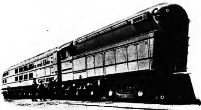
Sl. 16. Parna turboelektrična lokomotiva bez kondenzacije izlazne pare, izgrađena 1941. godine za Chesapeake & Ohio Railway Co., SAD. Graditelj: Baldwin Locomotive Works i Westinghouse Electric Corp., SAD. Masa lokomotive 594 t, snaga lokomotive 4500 kW
