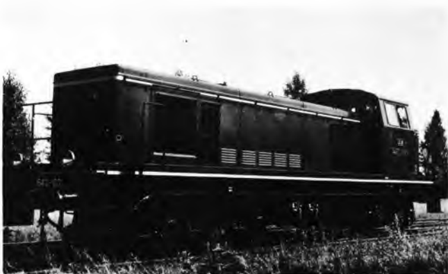
Sl. 32. Univerzalna dizelsko-električna lokomotiva Jugoslavenskih željeznica za manevarsku i laku pružnu službu, snage 600 kW. Izgrađena 1961. godine u tvornici Đuro Đaković (Slavonski Brod) prema licenci Brissoneau & Lotz, Paris
