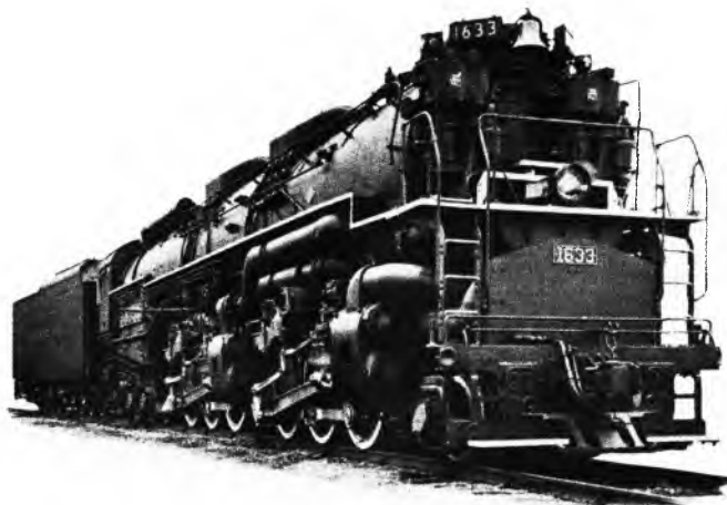
Sl. 12. Četverocilindrična parna stapna lokomotiva Chesapeake & Ohio Railway Co. (1943). Graditelj: Lima Locomotive Works Inc., Lima, Ohio, SAD. Masa lokomotive 327 t, masa tendera sa 2/3 zaliha 155 t, vučna sila lokomotive 490 kN.
