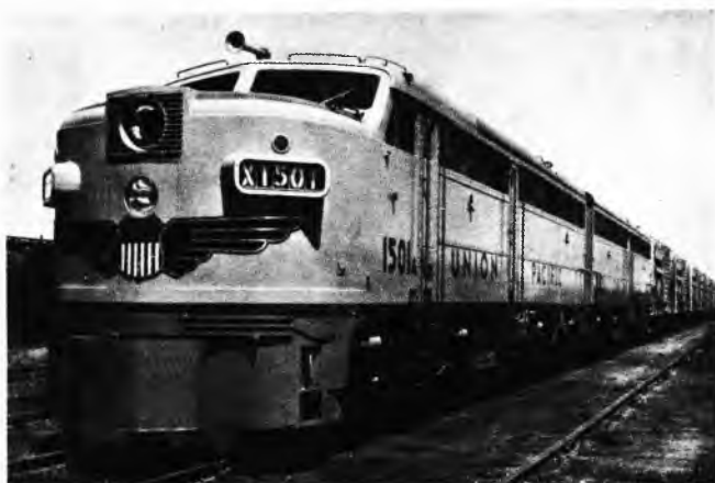
Sl. 33. Pružna dizelska lokomotiva snage 2200 kW, izgrađena u tvornici American Locomotive Co., Schenectady, SAD, za Union Pacific Railroad
