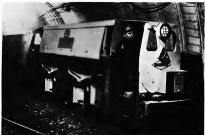
Sl. 80. Dizelska hidraulička lokomotiva za rad u rudničkim jamama tvornice Klockner-Humboldt-Deutz. Snaga 66 kW, masa 14 t, maksimalna brzina 3,78 m/s (13,6 km/h)
