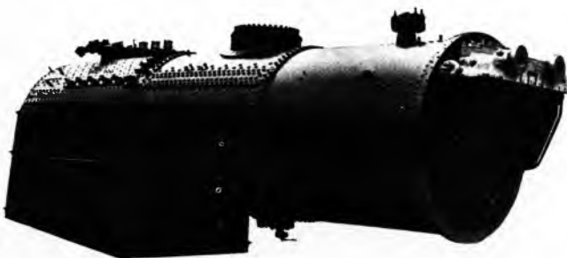
Sl. 18. Opći izgled lokomotivskog parnog kotla. Dimnjača je skinuta, pa se vidi glava pregrijača
