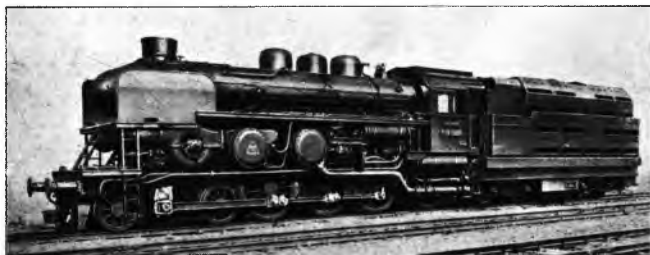
Sl. 14. Parna turbinska lokomotiva s kondenzacijom izlazne pare Njemačkih željeznica (1924). Graditelj: Krupp A. G., Essen
