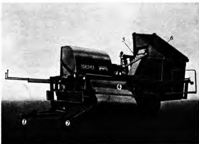
Sl. 117. Vučeni dvoredni kombajn za berbu boranije. 1 poteznica vučenog kombajna, 2 razdeljivači grmova između susednih redova, 3 berački rotor, 4 uređaj za čišćenje, 5 elevatorska traka do bunkera, 6 bunker za mahune
