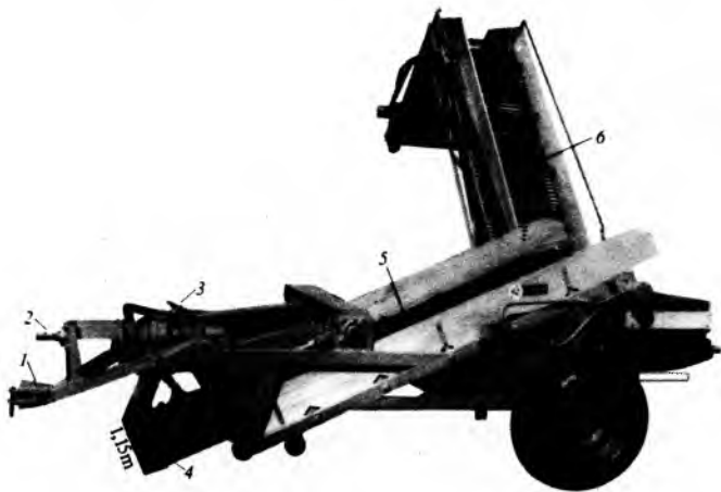
Sl. 113. Vučeni kombajna za potkopavanje. 1 poteznica, 2 priključak na vratilo traktora, 3 pumpa za pogon hidrauličnog motora, 4 daska za potkopavanje, 5 transportna traka, 6 elevator
