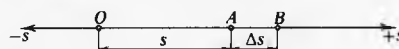
Sl. 1. Gibanje čestice po pravocrtnoj putanji. Put s predstavlja udaljenost čestice od ishodišta O (pol)
