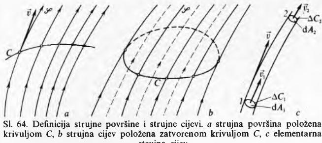
Sl. 64. Definicija strujne površine i strujne cijevi. a strujna površina položena krivuljom  $C$ , b strujna cijev položena zatvorenom krivuljom  $C$ , c elementarna strujna cijev
