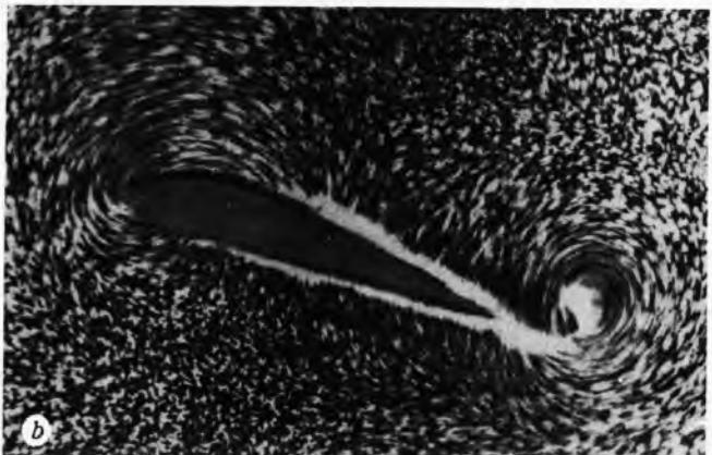
Sl. 60. Snimka strujanja u početnoj fazi optjecanja vode oko krilnog profila, vizualiziranog aluminijskim česticama. a fotografski aparat miruje relativno prema profilu, b fotografski aparat miruje relativno prema vodi udaljenoj od profila
