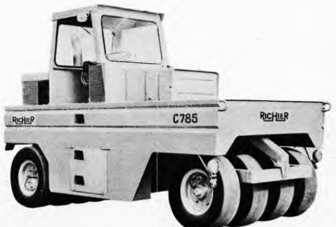
Sl. 13. Kompaktor sa 4 + 5 pneumatika, mase 9,0...27t i snage motora 70,7kW (96KS)
