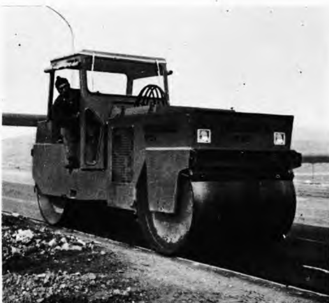
Sl. 15. Dvojni vibracioni valjak na hidraulični pogon, mase 7,0...8,5 t
