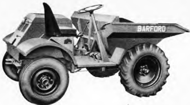
Sl. 19. Mini damperi za unutrašnji prevoz na gradilištu
