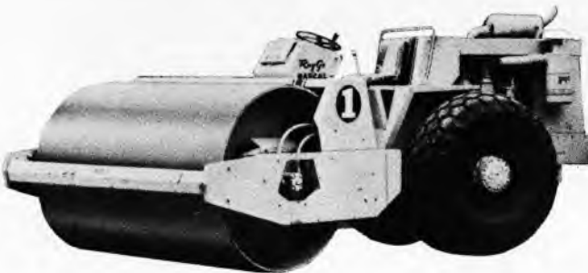
Sl. 14. Glatki vibracioni valjak, mase 9,1 t, snage motora 69,9 kW (95 KS), sa 2300 \text{min}^{-1}
