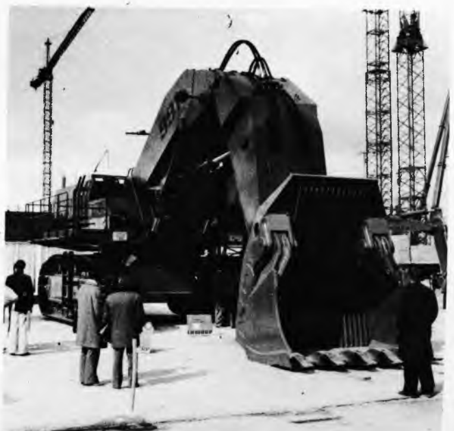
Sl. 5. Hidraulični bager sa čeonom kašikom, snage motora 420 kW (572 KS) i zapreminom kašike 4,6 m 3
