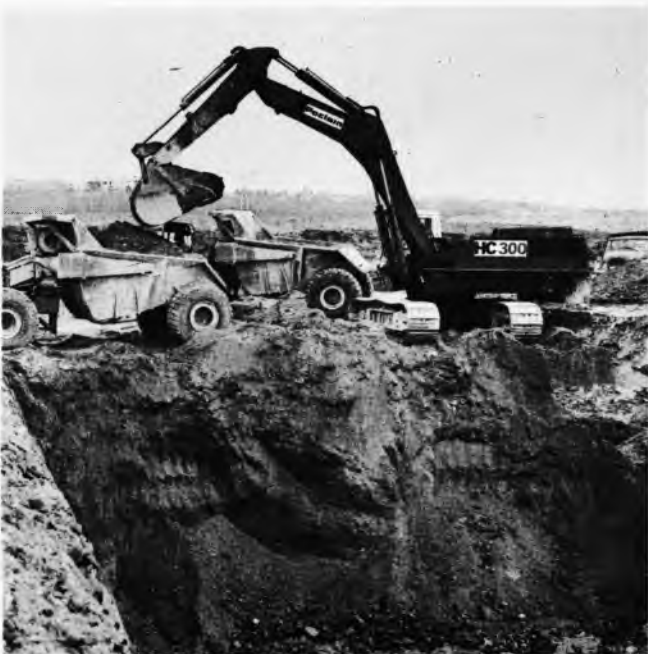
Sl. 4. Hidraulični bager sa dubinskom kašikom, snage motora 220,8 kW (300 KS) i zapreminom kašike od 3,0 m 3
