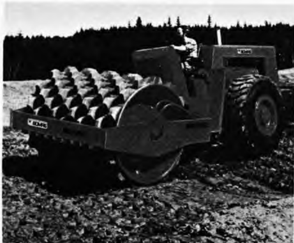
Sl. 12. Samohodni vibracioni jež, mase 9,0t, snage motora 82,3kW (112KS) sa 2500min -1
