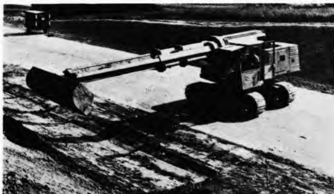
Sl. 6. Bager sa teleskopskom kašikom zapremine 800L, snage motora 73,6kW (100KS) i dometom u daljinu 10,0m, u visinu 6,3m i u dubinu 7,4m
