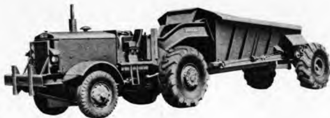
Sl. 21. Istovarivač kroz dno, nosivosti 25 t, snage motora 220,8 kW (300 KS), zapremine koša 15 m 3
