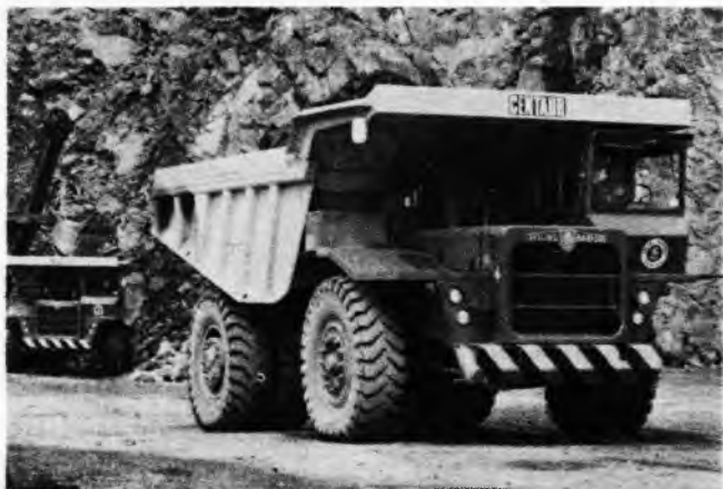
Sl. 20. Istovarivač pozadi (damper), nosivosti 40 t, snage motora 312,8 kW (425 KS), zapremine koša 19 m 3
