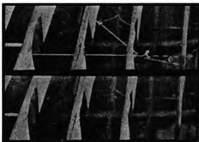
Sl. 9. Dvostruko raspršenje fotona u Compton-Simonovu eksperimentu. Na gornjem dijelu slike označeni su smjerovi upadnog i raspršenog fotona i pokrenutog elektrona
