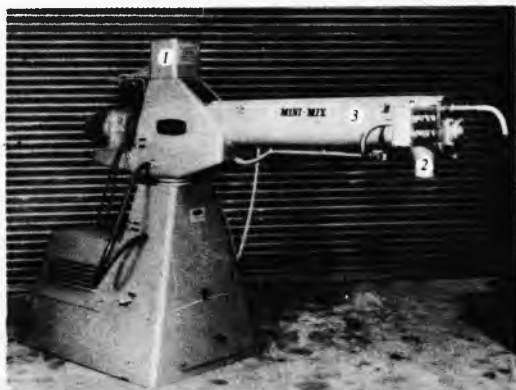
Sl. 33. Jednokanalna vijčana spora miješalica. 1 ulaz, 2 izlaz kalupne mješavine, 3 kanal za miješanje
