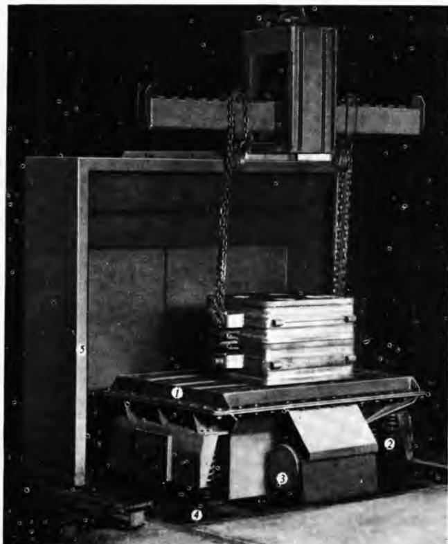
Sl. 84. Istresna rešetka. 1 rešetkasta platforma, 2 opruge, 3 vibracijski motor, 4 rešetka u podu kroz koju propada višak pijeska, 5 kabina za otprašivanje
