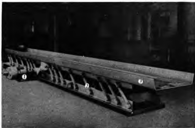
Sl. 12. Vibracijski žlijebni transporter. 1 pogon, 2 lisnate opruge, 3 žlijeb
