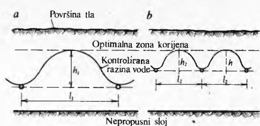
Sl. 18. Raspored i dubina drenažnih cijevi uz jednaki efekt odvodnjavanja. a veća dubina i veći razmak, b manja dubina i manji razmak drenažnih cijevi
