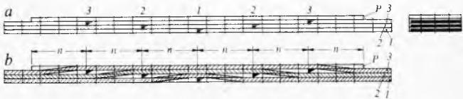
Sl. 23. Jednostrani, direktni stepenasti nastavak paketa lamela. a raspored podvezica za nastavak lamela, b tok linija sila u prelazu (uz jednak debjinu lamela jednak je broj zakivaka  $n$  u svakom delu)
