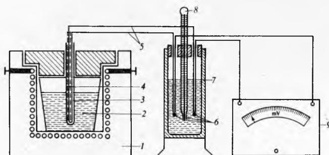
Sl. 46. Urđaj za termičku analizu. 1 električna peć, 2 posuda s talinom, 3 zaštitna cjevčica, 4 izolacijska cjevčica, 5 termoelement, 6 hladni priključak, 7 Dewarova posuda, 8 termometar, 9 galvanometar
